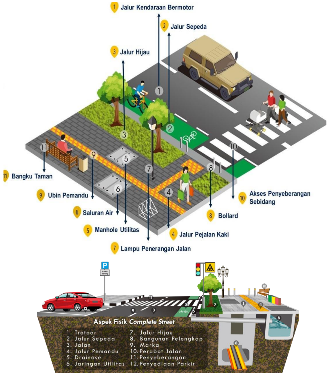
Gambar 42 Jalan yang lengkap beserta perlengkapan jalan Sumber: Data Dinas Bina Marga
